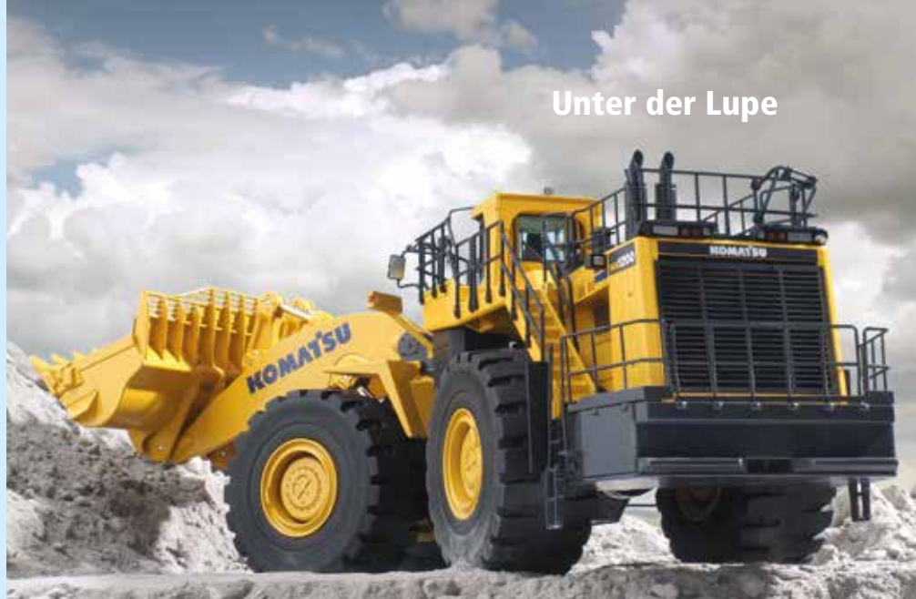
Auch als Modell von NZG wirkt der Komatsu WA1200-6 ausgesprochen kraftvoll. Der Kühlergrill besteht aus einem fotogekätzten Bauteil.
