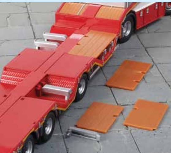
Originalgetreu können die Auffahrampen im verschliessbaren Fach am Heck verstaut werden
