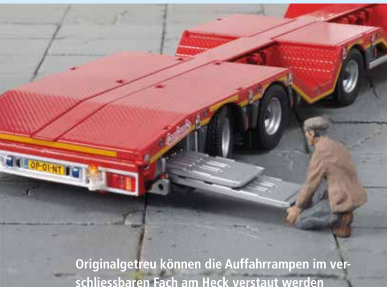
Die Beladung erfolgt über das Heck – durch die Radmulden kommen die Maschinen sehr tief zu liegen.
