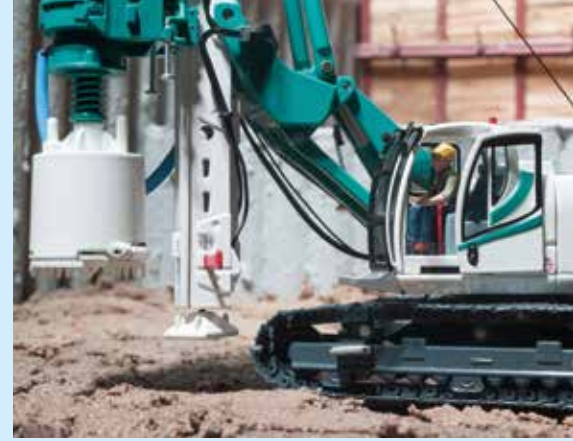
Bohrtopfe werden bei unverrohrten Bohrungen verwendet.
