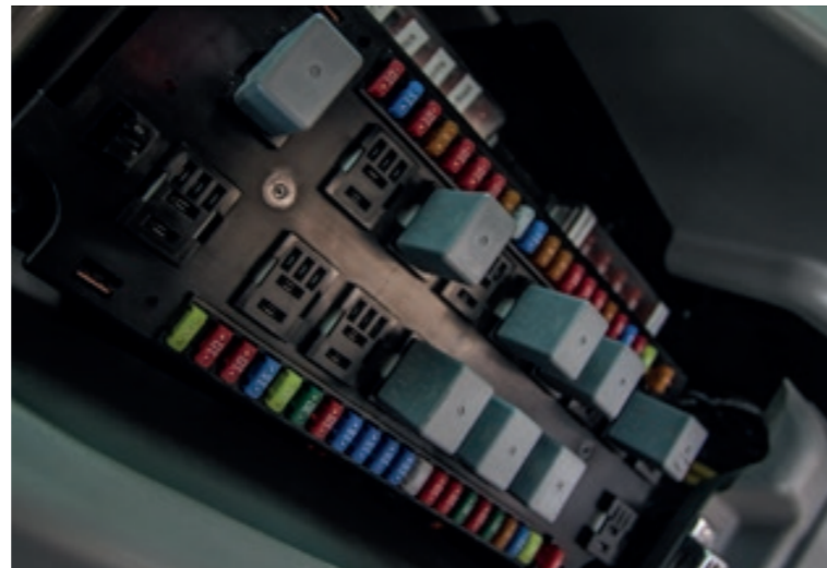
Elektronica maakt de laatste decennia een niet te stuiten opmars. Dat zie je prachtig in de zekeringenkastjes. Volstonden vroeger nog deze 10 glaszekeringen, tegenwoordig zijn er al minimaal zo'n 50 nodig. In dit geval zijn nog zo'n 20 extra zekeringen bijgeplaatst voor het afzekeren van alle opgebouwde extra's.
