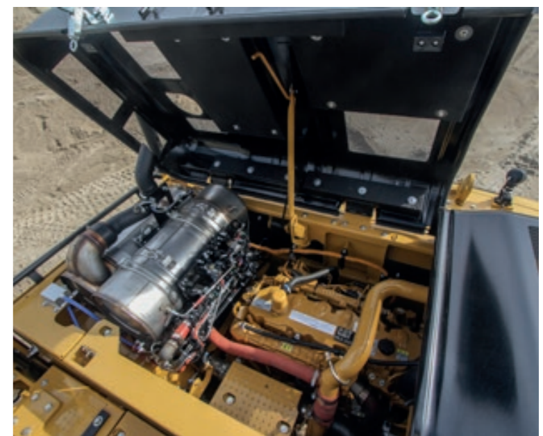
We kennen het beeld; de schonere motoren van nu vereisen een batterij aan koelers én aan uitlaatgasbehandeling. AdBlue tanken is nu een must.
