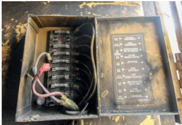
Elektronica maakt de laatste decennia een niet te stuiten opmars. Dat zie je prachtig in de zekeringenkastjes. Volstonden vroeger nog deze 10 glaszekeringen, tegenwoordig zijn er al minimaal zo'n 50 nodig. In dit geval zijn nog zo'n 20 extra zekeringen bijgeplaatst voor het afzekeren van alle opgebouwde extra's.
