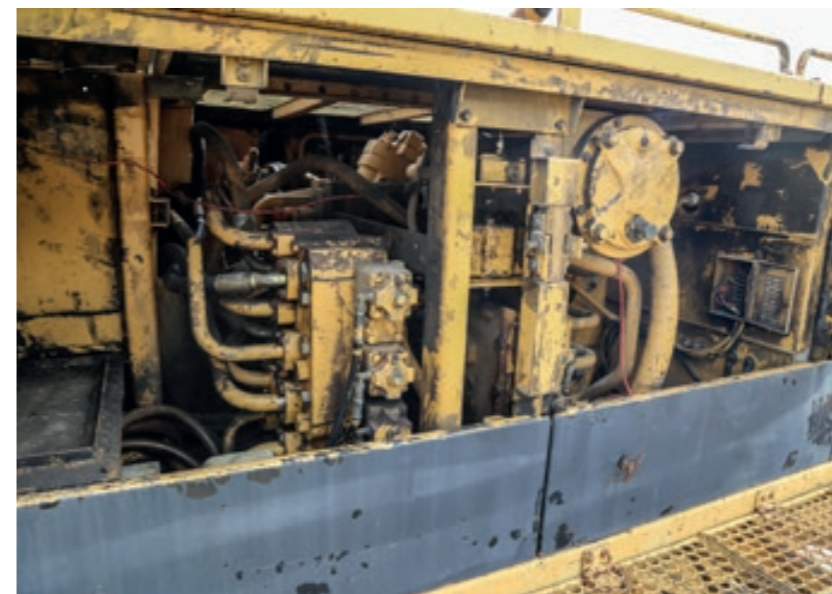
Zo ging het vroeger. De motor dreef grote pompen aan die veel liters gaven. Elk hydrauliekblok had zijn eigen functie en stuurde de olie door wanneer deze het commando kreeg.
