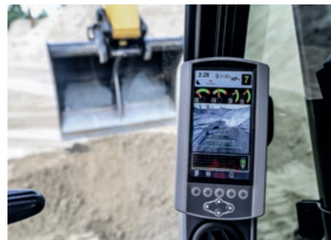
Opmars van de ICT is niet te stuiten; camera's, 3D-gps, programmeerbare functies en het opslaan en op afstand uitlezen van de machines. Alle merken leveren het heden ten dage.
