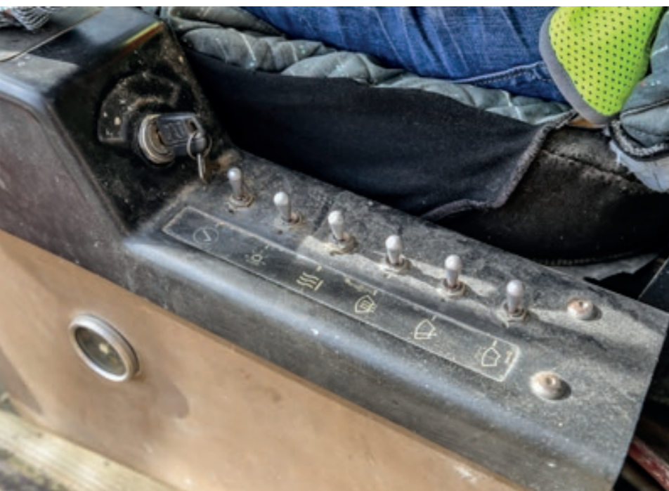
Geen terminal, geen menu's en touchscreen, maar zes grote tuimelschakelaars bedienen alle elektronica op de 235B.
