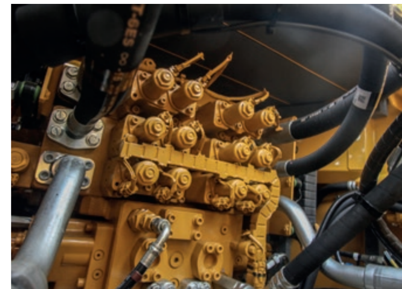
De laatste stand der techniek; solenoids sturen de hydrauliekblokken elektronisch aan waardoor de oliestroom optimaal aangestuurd en benut wordt.
